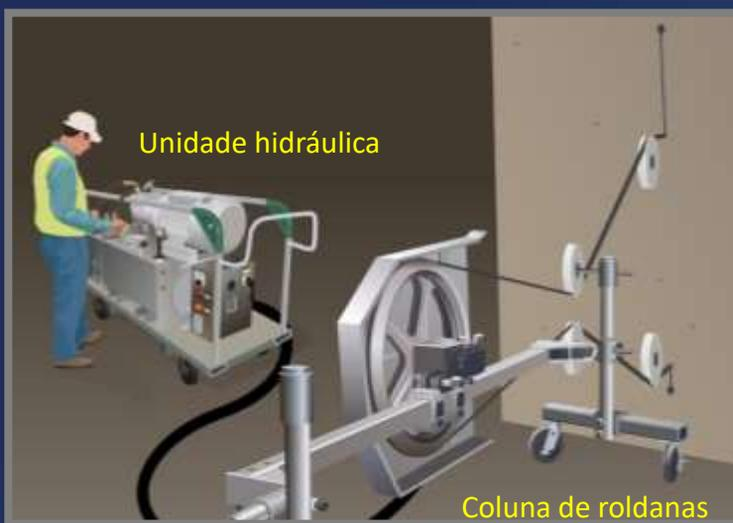
Foto 23 – Esquema com disposição de equipamentos de corte com fio diamantado
